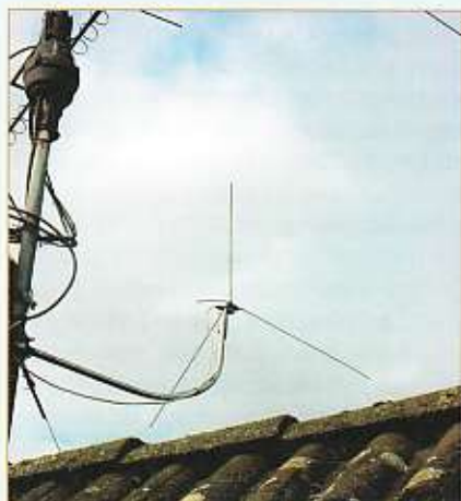
Zoals de GP vaak wordt aangetroffen, op een zijarm aan de mast. Gezien de afmetingen zal deze voor de tweemeterband bestemd zijn.
